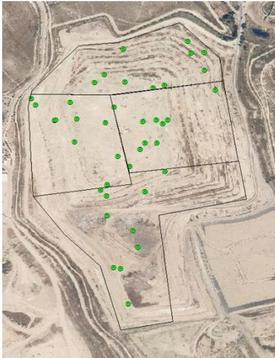
Figura 7. Puntos de muestreo para análisis cuantitativo de emisiones en vertedero B
