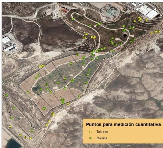
Figura 5. Puntos de muestreo para análisis cuantitativo de emisiones en vertedero A
